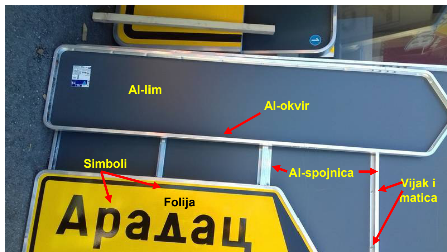
Slika 6: Konstruktivni elementi znaka za vođenje saobraćaja
